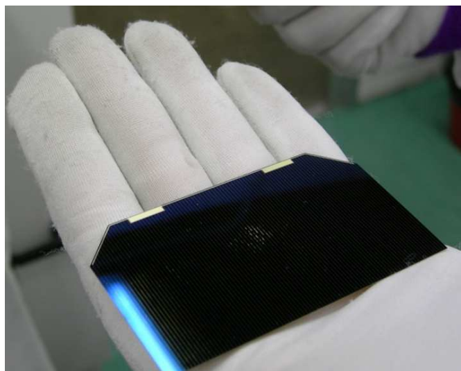
Рис. 1. Трехкаскадный солнечный элемент космического назначения, изготовленный в технологической лаборатории ОАО «НПП «Квант».
